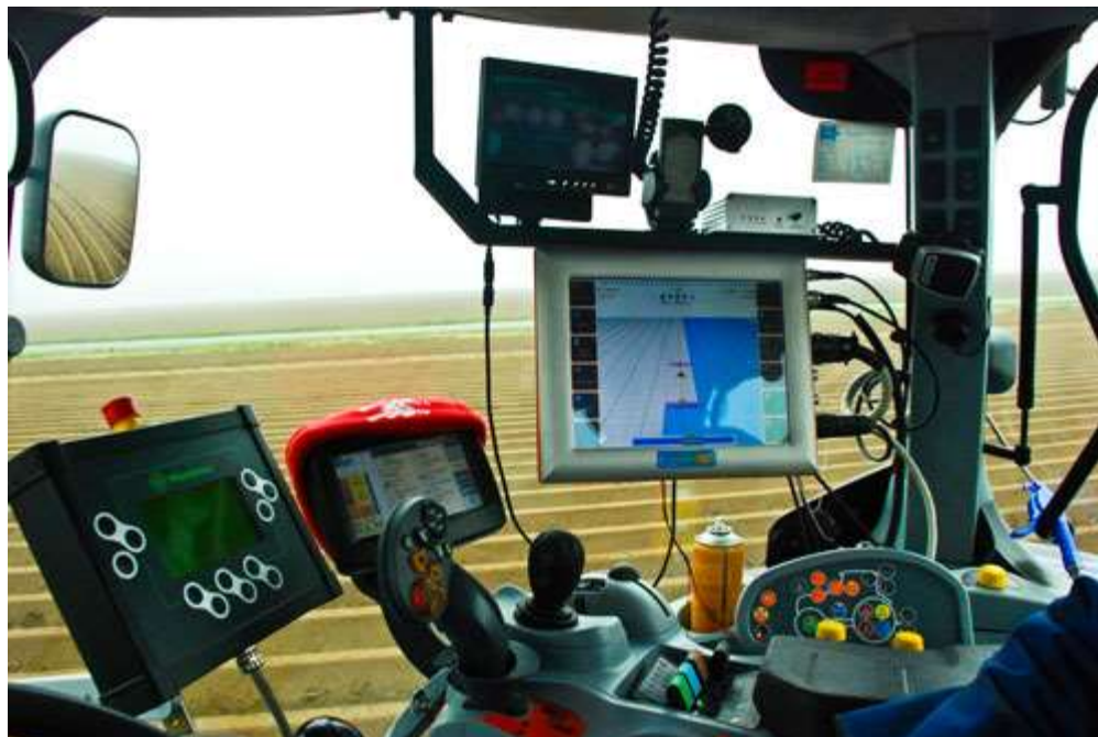
داخل کابین یک ماشین کاشت مجهز به سیستم GPS
